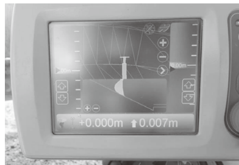
写真 2 マシンガイダンスショベルによる法面整形状況（左）、操縦席のモニター画面（右）
